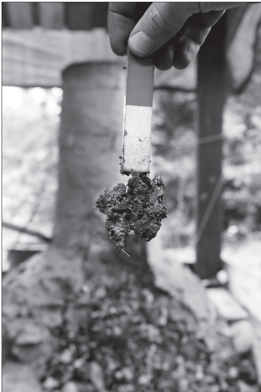
6. att. Jēldzelzs fragments pēc izņemšanas no krāsns. L. Palmas foto
