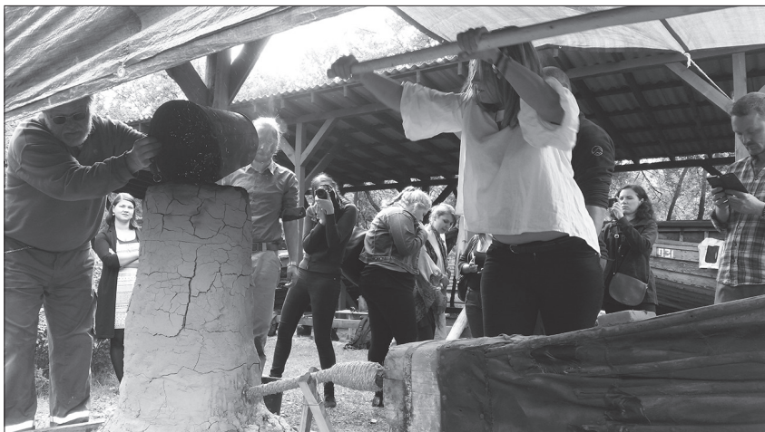
4. att. Dzelzs rūdas un ogļu maisījuma papildināšana eksperimenta procesa gaitā. A. Vijupa foto
